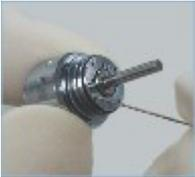
2. Sortez la broche de nettoyage à l'extrémité arrière de la brosse et **insérez-la en ligne droite** dans l'orifice de spray.
